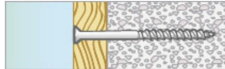
1. Lettbetongskruen skrues rett inn i lettbetongen, ingen krav til forboring. I tre: Hvis forankringsdetaljene av tre skal forbores bør dette testes. Faktorer som påvirker evt. forboring av tredetaljen er f.eks hvis monteringen er for nær ytterkant, detaljen er tynn og sprø, lettbetongen er av dårlig kvalitet etc. I stål: Ved oppsetting av tynne stålstendere ( $<0,7$  mm) kan man bruke et lett hammerslag for å lage et hull i stålstenderen og deretter skru inn skruen.
